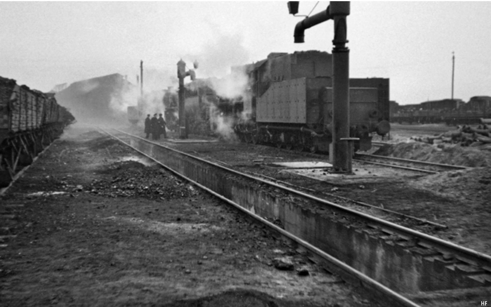
Drei 52er vertreten im Bw Berditschew (von links nach rechts) alle drei für diese Baureihe verwendeten Tendertypen, nämlich den Kastentender der 50, den vom Kesselwagenbau abgeleiteten Wannentender und den Floridsdorfer Steifrahmentender.
