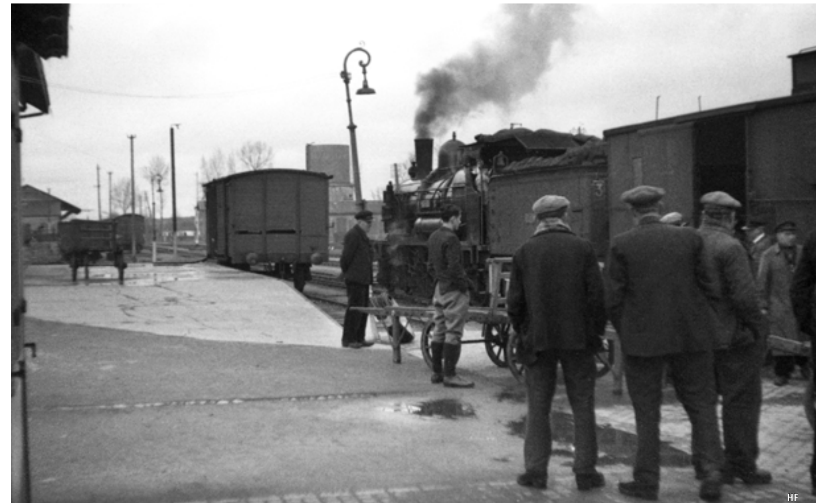
Heinz Finzel ist in Westfrankreich zwischen Tours und dem Atlantik angekommen. Mehrere Aufnahmen widmete er der Lok 230-028 der Verwaltung ETAT. Sie entstammte der Serie 3701-3755 und vertritt als 2'C n4v mit äußeren Hoch- und inneren Niederdrucktriebwerken charakteristisch die Bauart de Glehn. Mit einem Treibraddurchmesser von 1750 mm (wie bei der preußischen P 8) war sie eine typische Personenzuglok. Gebaut wurden die Loks 1901-09 von Fives Lille, SFCM sowie Schneider & Co. Die Umzeichnung auf 3-230.B.1-55 der SNCF steht bevor.
