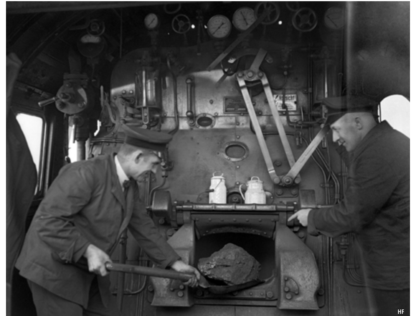
Der Lokführer amüsiert sich über den riesigen Kohlebrocken, den der Heizer mit Mühe in die Feuerbüchse wuchtet. Üblicherweise zerklüftete man solche Giganten mit der Kohlenhacke. Unter dem Parallelogrammgestänge des Reglers nach preußischer Tradition bilden zwei emaillierte Kaffeekannen die einzigen hellen Bildelemente zwischen den Fenstern des Führerhauses.
